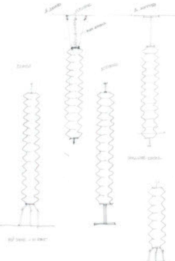
Milano è realizzato in acciaio verniciato con elementi modulari da 13 cm di altezza e 26 di larghezza massima.
