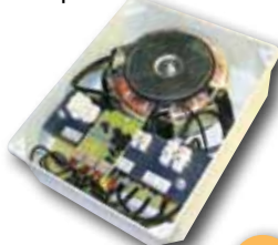
Трансформатор ТТ300-Е1 в электромонтажной коробке (размеры коробки: 255x205x71 мм), , мощность 300 ВА Трансформатор ТТ240-Е1 в электромонтажной коробке (размеры коробки: 255x205x71мм), мощность 240 ВА
